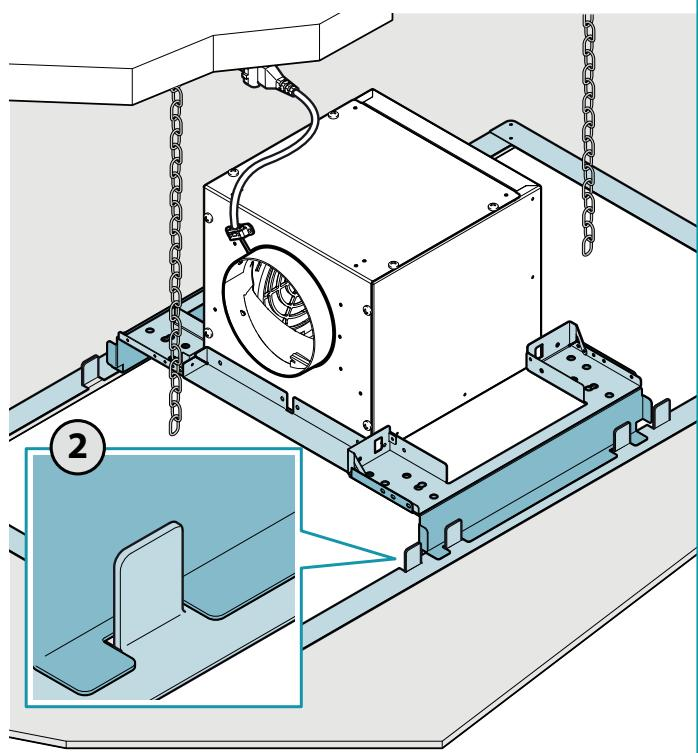
IT - Montaggio tubo d'aspirazione e collegamento elettrico (9).
