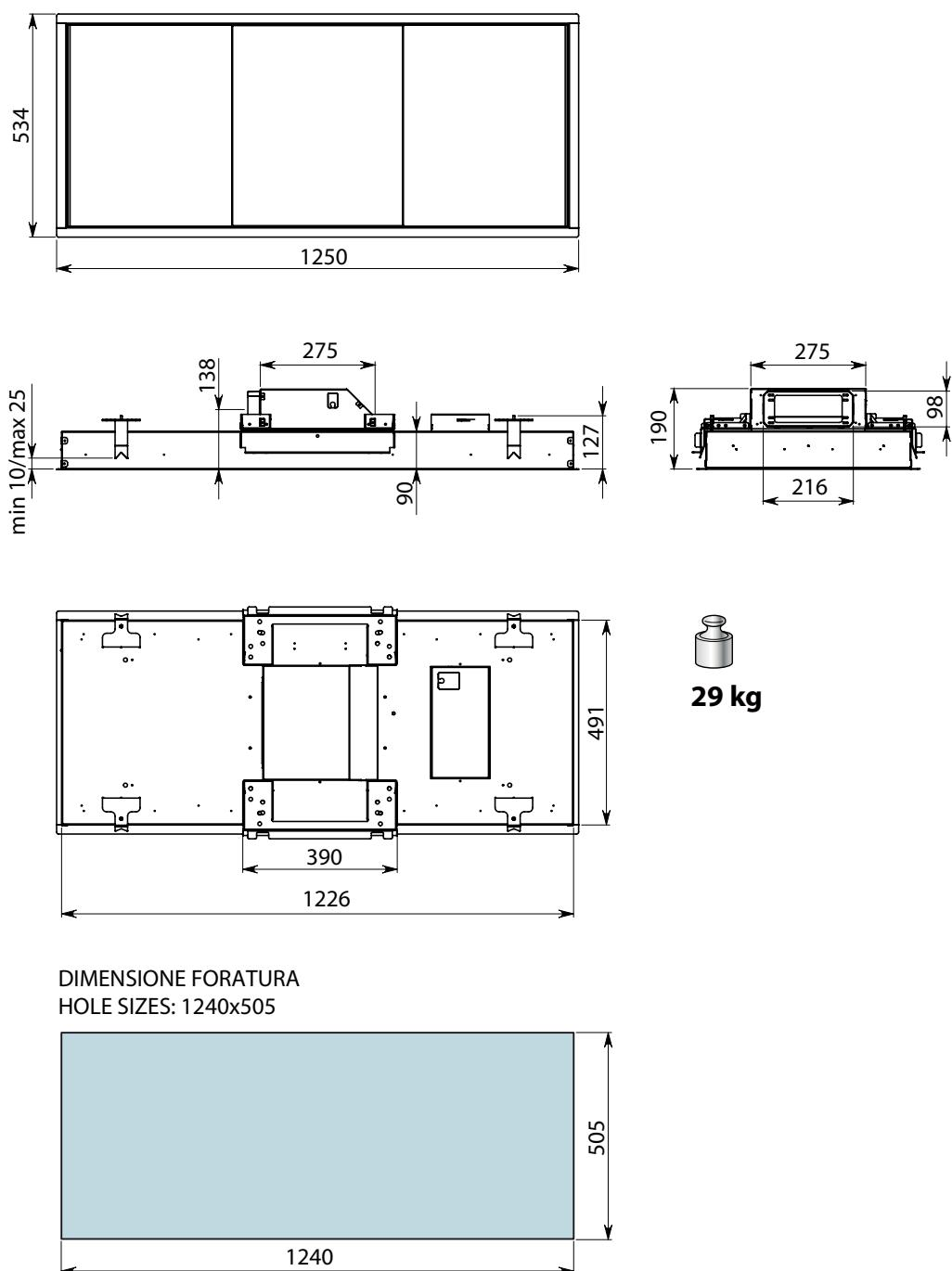
IT - Installazione con motore remoto.
